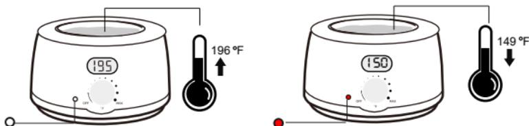
Verá que el indicador luminoso pasa de rojo a apagado cuando se alcance la temperatura deseada.
